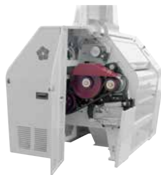
Встроенный привод для перехода между форматами как замена для маховика
