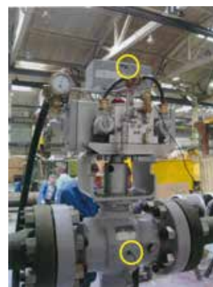
Расположение акселерометров, регистрирующих локальные ускорения от динамических воздействий, заданных на корпус крана и привода
