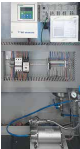
Шкаф управления разработан для размещения электрических и пневматических устройств
