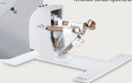
Прецизионная диагностика: робототехнический комплекс RCM от Soteria Medical предназначен для точечной биопсии тканей в подозрительных зонах простаты.
