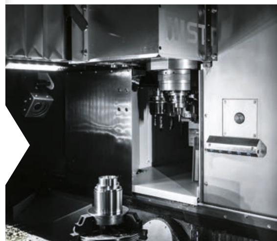
Надежно закрывается — с Festo Motion Terminal VTEM и Motion App «Soft Stop» крышка смены инструмента перемещается быстро и с необходимым демпфированием.
